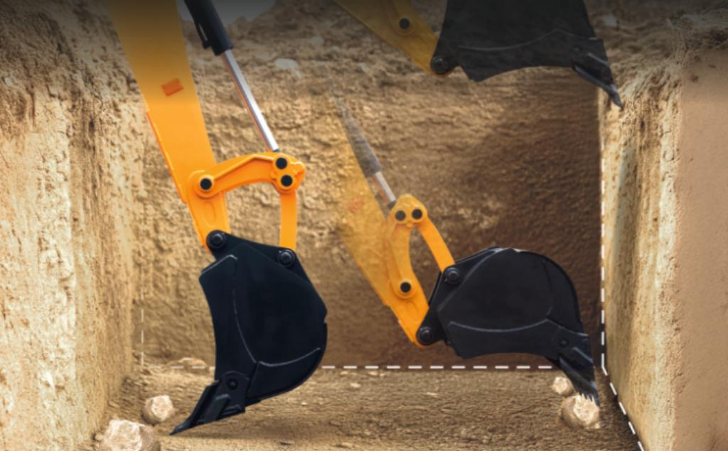
Diseñado específicamente para cortes cuadrados precisos en zanjas de cimentación, tanques de agua, fosas sépticas y trincheras, respondiendo a la demanda de los ingenieros civiles.
